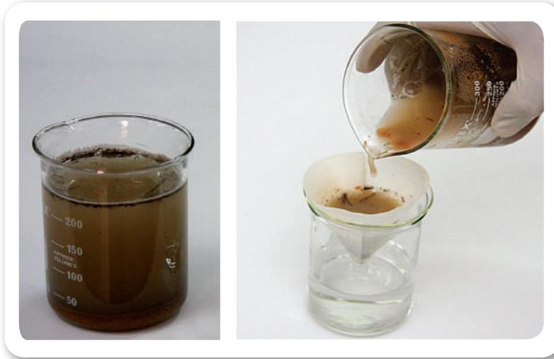
الشكل 1-2 يمكن فصل المخلوط المعلق إذا ترك دون تحريك فترة من الزمن، أو فصله بالترشيح.
